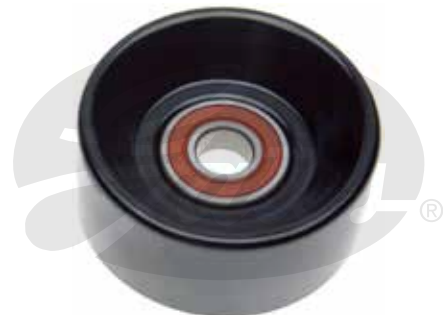
I.D. : 17mm, O.D. : 90mm, Width : 39.5mm
